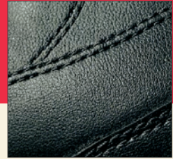
PU Synthetisches Material, das ähnliche Eigenschaften besitzt wie Leder: Weich, geschmeidig und länger haltbar, selbst unter härtesten Bedingungen.
